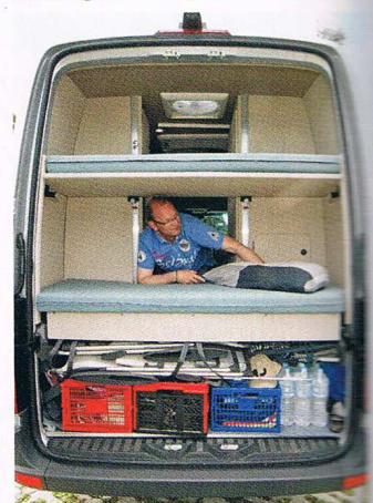
Die Betten lassen sich höhenverstellen oder ganz entnehmen.
