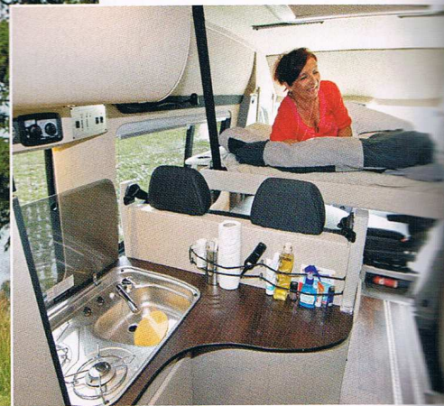
Das elektrische Hubbett schmiegt sich tagsüber eng an die Decke.
