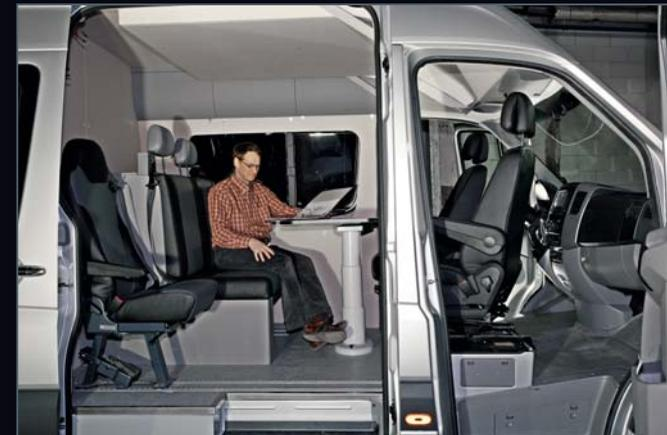
Der Einzelsitz kann bis zur Trennwand verschoben werden, so dass der breite Einstieg erhalten bleibt. Der Tisch ist in alle Richtungen schwenkbar und auch in der Höhe variabel
