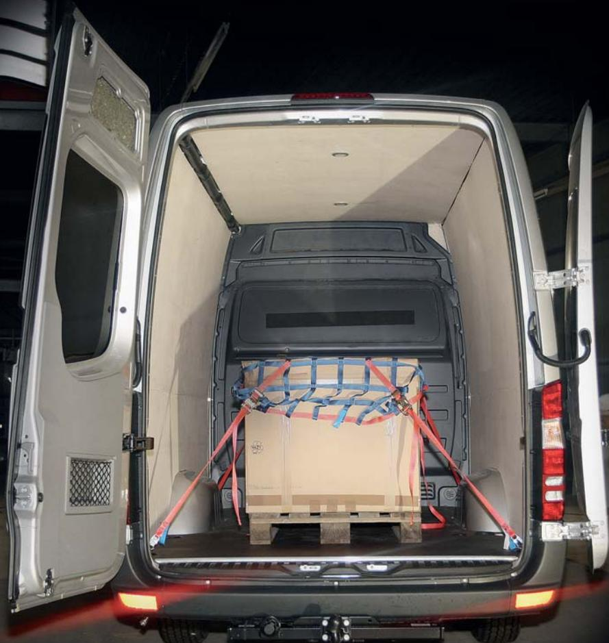
Der Laderaum ist ausgekleidet und mit einem Holzladeboden ausgerüstet. Die Begrenzung zum Fahrerhaus bildet eine serienmäßige Mercedes-Benz-Stahlblechtrennwand
